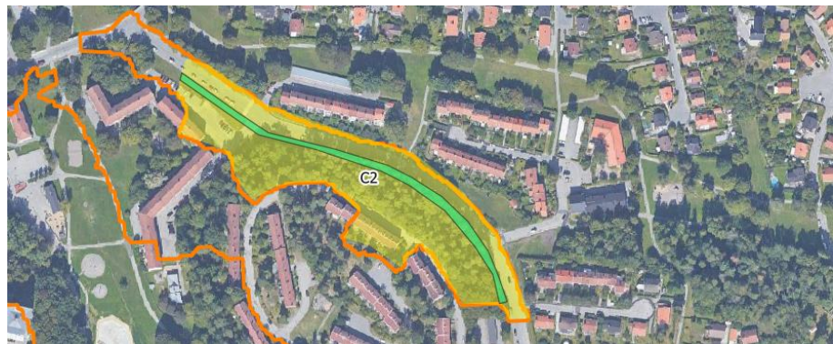
Figur 3. Åtgärd C2 (grön yta), avrinningsområde till diket (gul yta) och gräns för tillrinningsområdet till Råcksta trask (orange linje). Kupolsilen som ansluter till dagvattenledning i gata föreslås anläggas vid den nordvästa delen av diket. Figur baserat på GIS-underlag från Sweco 2017, se referenser.
