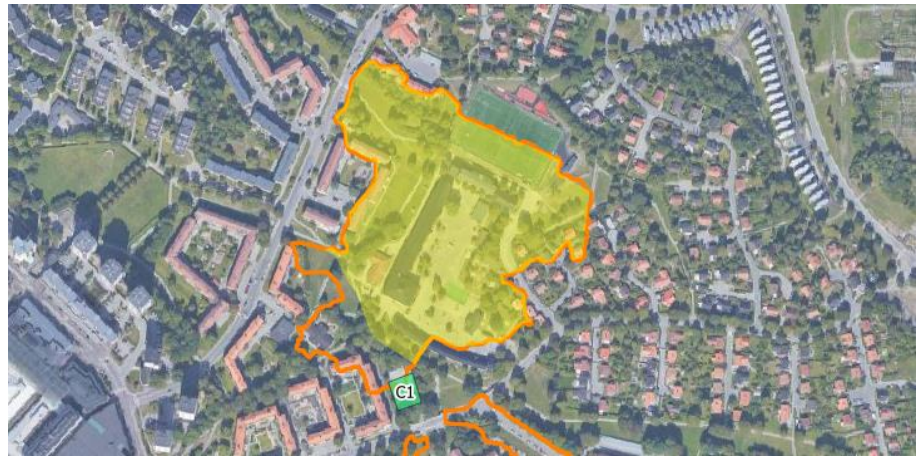
Figur 2. Åtgärd C1 (grön rektangel), avrinningsområde till avsättningsmagasin (gul yta) och gräns för tillrinningsområdet till Räcksta träsk (orange linje). Figur baserat på GIS-underlag från Sweco 2017, se referenser.
