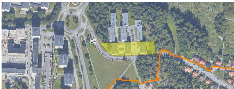
Figur 5. Avrinningsområdet som leds till växtbädd är markerat i gult, läget för växtbädden är markerat med grön punkt. Gränsen för tillrinningsområdet för Råcksta trask är markerat med orange linje. Figur baserat på GIS-underlag från Sweco 2017, se referenser.
