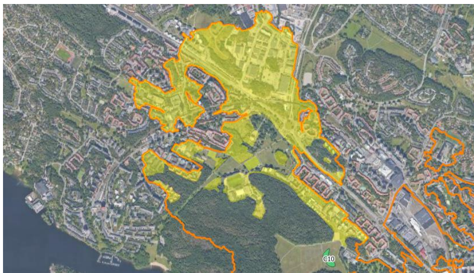
Figur 12. Åtgärd C10 (grön yta), avrinningsområde till dagvattendamm (gul yta) och gräns för tillrinningsområdet till Räcksta träsk (orange linje). Figur baserat på GIS-underlag från Sweco 2017, se referenser.
